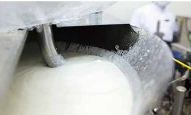
発酵を終えたヨーグルトは殺菌処理したパイプを通り、隣接する充填室へ
