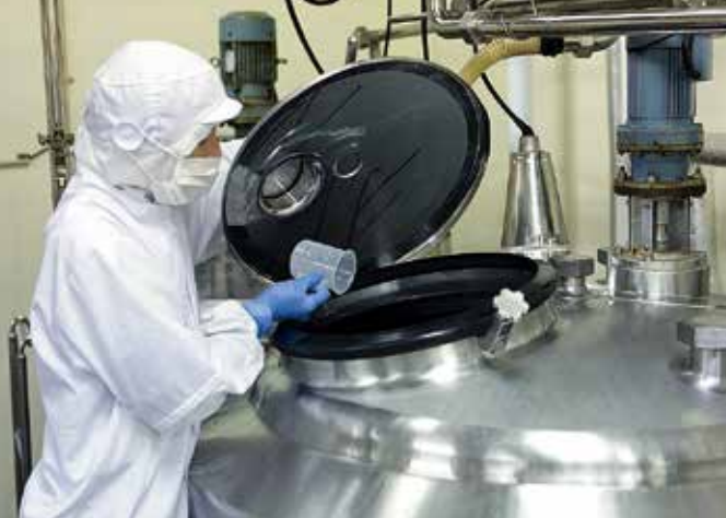
600ℓタンクの牛乳に乳酸菌を入れて5時間ほど発酵。タンク1つにつき、250mlパックのヨーグルト2400個分を製造する
