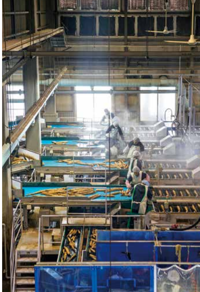
JA帯広かわにし敷地内にある選果場。洗浄やサイズ、形の判別は最新機器にて。出荷前のチェックや箱詰めなどは人の目と手で行う
