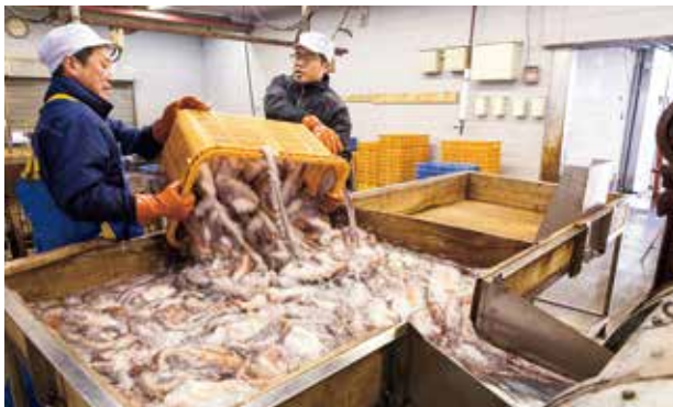
ドラム状の機械にたこの足と頭を入れ、ぬめりと余分な水分を取り除くもみ込みの作業
