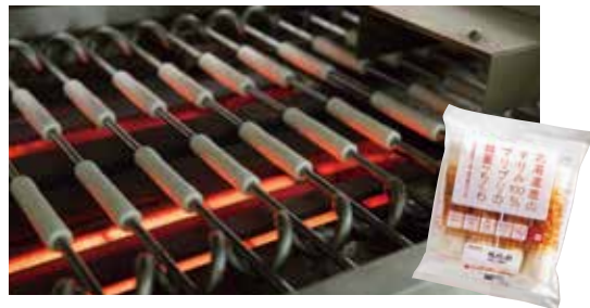
棒状にしたちくわの原料が通るラインは完成に近づくと共に温度が上がり、じっくりふっくら焼きあがる仕組み
