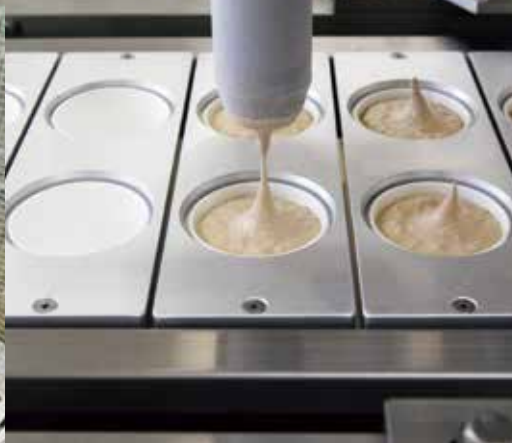
原料を調合し、フリージング作業を経たアイスクリームをカップに充填。この日はコーヒー味を製造
