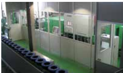
空洞・外観・糖度の判定をより高精度にするため「クリーンルーム」内にセンサーを設置
