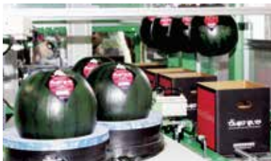
箱とラインを移動する際、すいかに傷がつかないようにする自動移載装置
