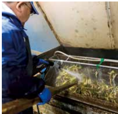
回転洗浄機で角材も使って土を落とす
