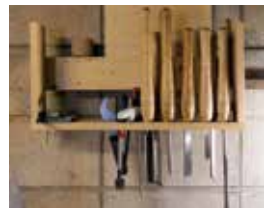
木を削る際に使用する「バイト」と呼ばれる専用の刃物
