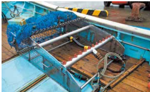
マンガンと呼ばれる漁具。中央に取り付けられたホースの先端から海水を噴射して海底の砂を掘り起こし、ホツキをかき出して袋網に送る
