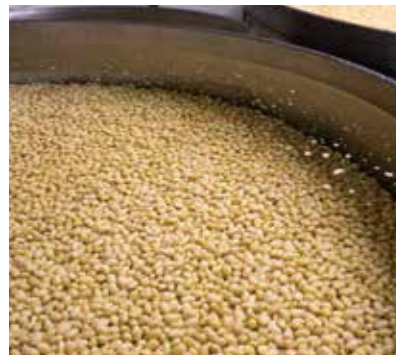
浸漬工程。芯まで水を吸わせる。たっぷり吸水した大豆は元の大きさの2倍に膨らむ
