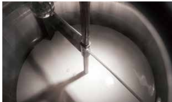
のむヨーグルトの製造タンク内。殺菌、培養(発酵)後、一定時間、回転・停止を繰り返すことで酸度、とろみのととのったヨーグルトが完成
