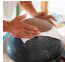
曲線を出すのに使うのは半分に切った浮き玉!「師匠から“道具は自分で作るもの”と教わりました」
