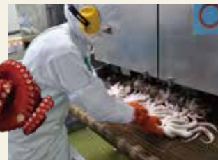
過熱水蒸気で柳だこを蒸し上げる。原料のサイズによって加熱時間を調整
