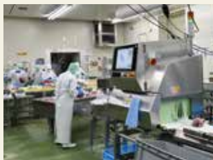
金属探知機やX線検査で異物混入がないかを確認。包装後に急速冷凍をかけて出荷する
