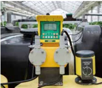
温室内に養液タンクを設置。苗ごとの生育計画に合わせて、必要な量が自動で供給される
