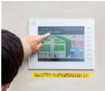
気温や湿度、日射量など、コンピュータによる管理システムで栽培に適した状態を保つ
