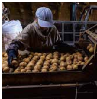
「とうや」の選果風景。規格外品はでんぶん原料に回し、廃棄をゼロにしている
