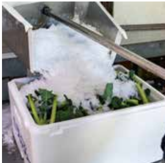
製氷機から出てくるのは一般の氷よりも温度が低い、薄くて平たい氷。氷漬けにして輸送
