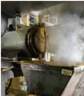
溶剤がかかりやすいよう、熱を加えて圧縮するクッキングの工程。再び乾燥後、抽出機へ
