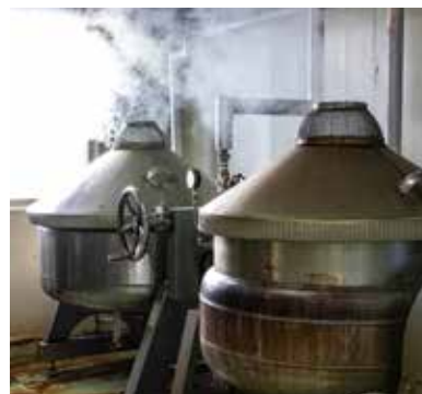
まき火で起こした蒸気をパイプで送り、水分を飛ばす平釜製法。3日目ようやく塩らしくなる
