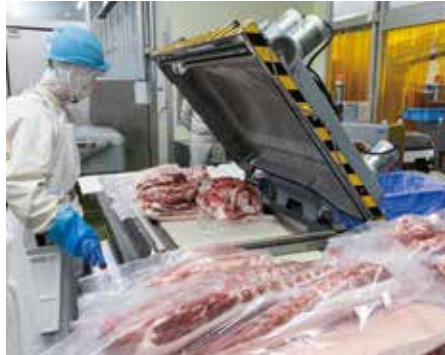
「整形」したお肉を真空パックにして金属探知機を通し、異物が混入していないか確認します
