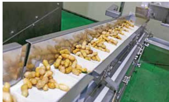
洗浄して土を落とし水に浸けた後、X線で“熟度”を選別。中熟以上が合格となり、製品化へ進む
