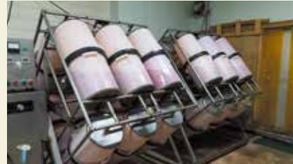
たらこ専用の転回機。原卵の芯まで塩が浸透するよう、サイズに応じて8~15時間漬け込む
