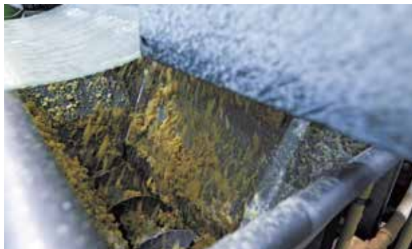
一次もろみにつぶしたさつまいもと水を加えて二次醗酵へ。二次もろみは2〜4週間ほど熟成させる
