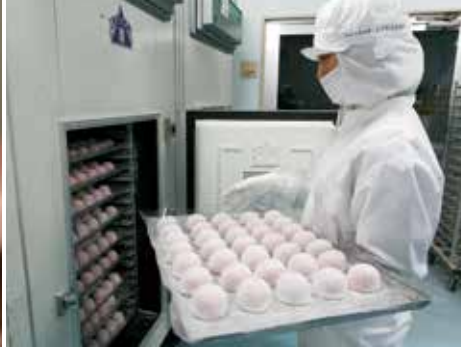
完成したソフト大福は専用の冷凍庫で急速冷凍。一気に冷凍することでつきたての風味とやわらかさを閉じ込める
