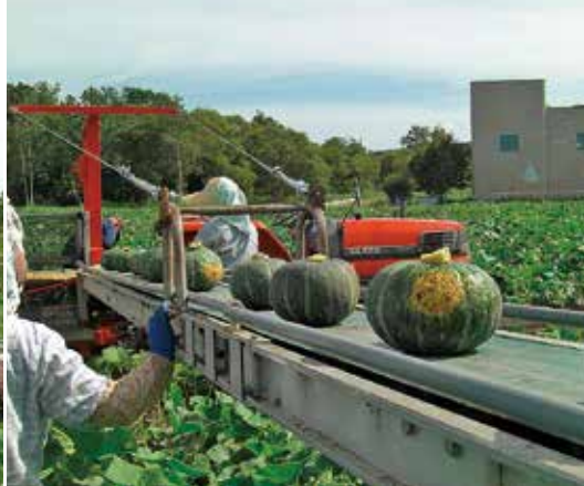
クマザワ農園では今季から、収穫したかぼちゃを傷つけないようコンベアで運ぶオリジナルのマシンを導入
