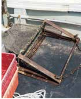
網と爪が一体になっているマンガン。船で引くと川底にいるしじみが網に入る仕組み
