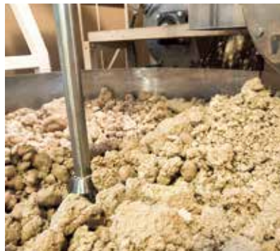
①フロージェッターという機械で、粉と水を均一にミキシングする
