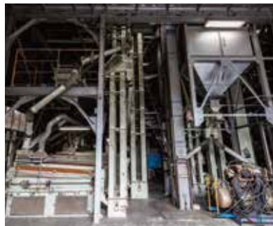
こちらは小豆用の巨大な選別機。上の階には貯蔵タンクを備える。収穫の始まる9月から、翌年3月頃まで稼働している
