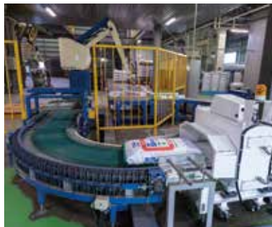
細かな選別を終えた後、袋詰めし、念には念を入れて金属探知機で最終チェック(写真は金時豆用の設備)
