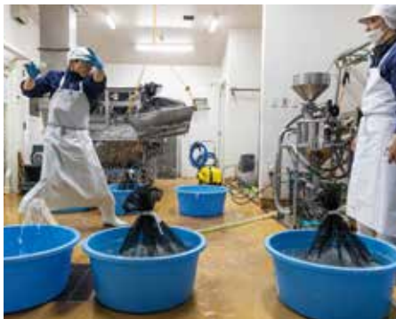
秒単位で調整が行われる浸漬作業(①)。浸漬を続けたお米は遠心力を使って直ちに水切りを行う
